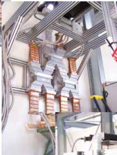
Um diese gewaltige Aufgabe bewältigen zu können, müssen diese Koppler vorher eingestellt und konditioniert werden. Die Prozedur des Konditionierens besteht aus einer schrittweisen und kontrollierten Anhebung der Hochfrequenz-Leistung auf die interne Koppler-Oberfläche im Hochvakuum. Hierbei werden verschiedene Phänomene, wie Oberflächenausgasung, elektrische Feldemission und Durchschläge sowie „Multipacting“, die im normalerweise bei betriebsfähigen Kopplern immer wieder auftreten, abgebaut.
