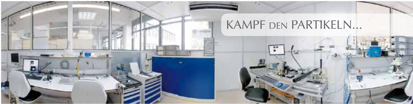
Seit 2011 besitzt SPINNER einen Reinraum nach ISO 14644-1:1999/ISO7. Diese ISO-Klasse bezeichnet eine sehr geringe Staubbelastung, wobei gerade die Partikel größer als 0.5 µm betrachtet werden.
